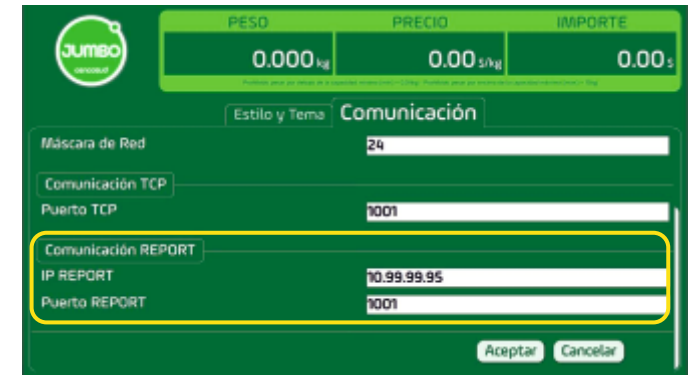
Configure IP 10.99.99.95 y Puerto 1001 de la Balanza Report NX, conectada a AutoReport. Confirme y grabe presionando Aceptar.
