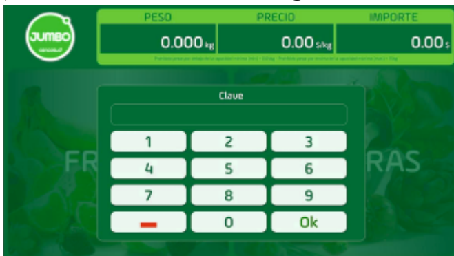
Digite la clave de fábrica 99999 para acceder a la configuración, presionando Ok al finalizar.
